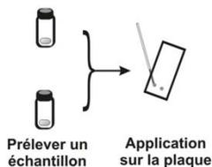
3. On utilise un capillaire pour déposer le produit sur la plaque puis on laisse évaporer le solvant. On peut spotter 2-3 fois si l'échantillon est très dilué.
